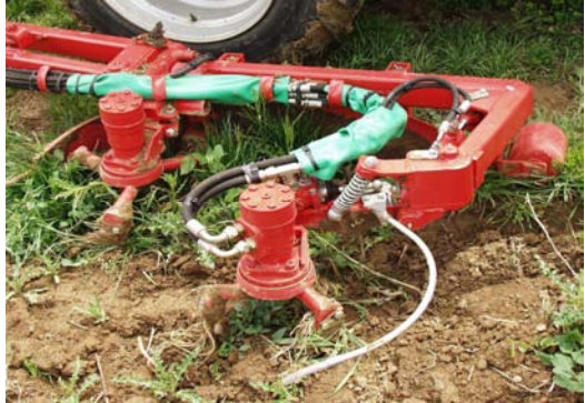
Abbildung 2: Werkzeugkopf mit rotierendem Werkzeug
