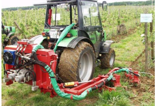
Abbildung 1: Einseitig arbeitender Ladurner- Krümmler Modell 5
